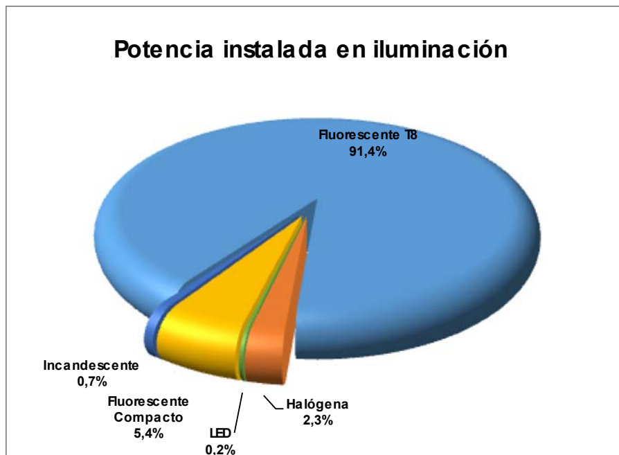
Gráfica 1. Distribución de la potencia instalada en iluminación según tipo de lámpara
